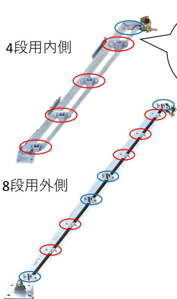
4段タイプの場合、**ステップ固定部分**と**手摺固定部分**の片側10本、両側で20本のボルトを緩めると高さ（ステップの傾き）が調整できます。
